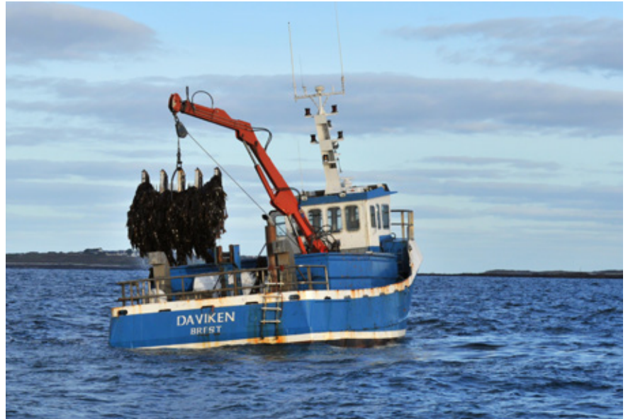
Récolte de Laminaria hyperborea avec la technique du peigne
